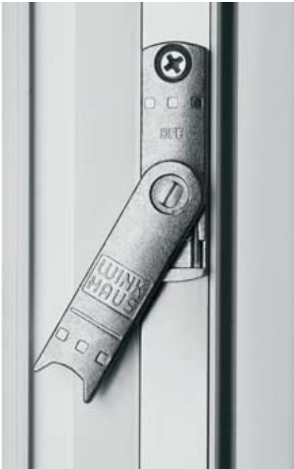
Duo-Funktionselement: Die Fehlschallsicherung verhindert eine Fehlbedienung des Fensters und beugt damit Schäden an Beschlag und Fenster vor. Zusätzlich sorgt eine integrierte Auflaufstütze für einen präzisen Einlauf des Flügels in den Rahmen.
