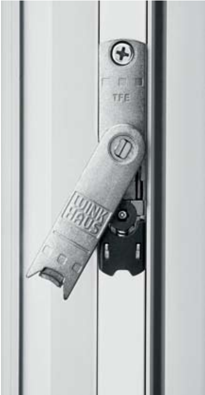
Tri-Funktionselement mit Fehlschallsicherung, Auflaufstütze und Balkontürschnapper, der den Flügel ohne Verschließen im Rahmen hält.
